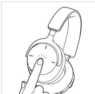
ハウジングに内蔵されたセンサーにより、AVENTHO 200 を置くと再生が自動的に停止し、AVENTHO 200 を装着すると自動的に再生が開始します。
